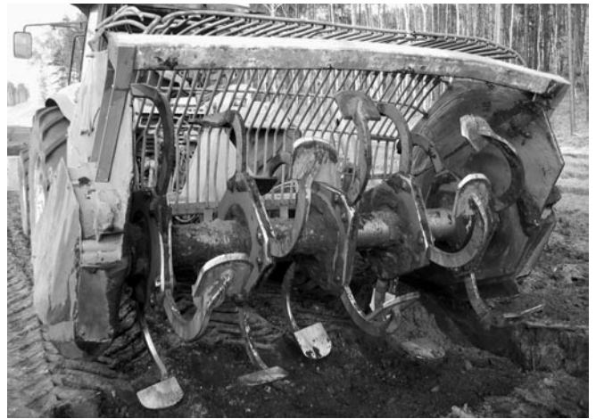
Abb. 3: Tiefspatenfräse. Quelle: LMBV.
