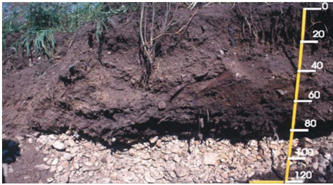
Abb. 2: Foto einer Methanoxiationsschicht aus Klärschlammkompost mit holzigem Strukturmaterial und darunterliegender Gasverteilungsschicht aus Grobschotter. Quelle: ABF-BOKU.
